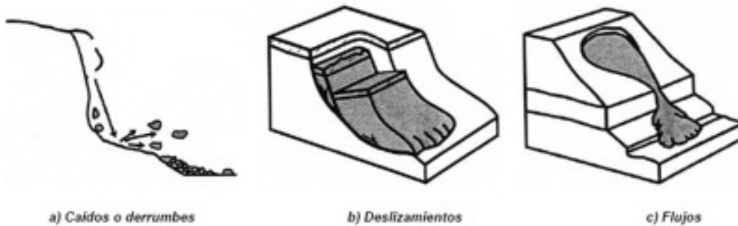
Principales tipos de deslizamientos en laderas
