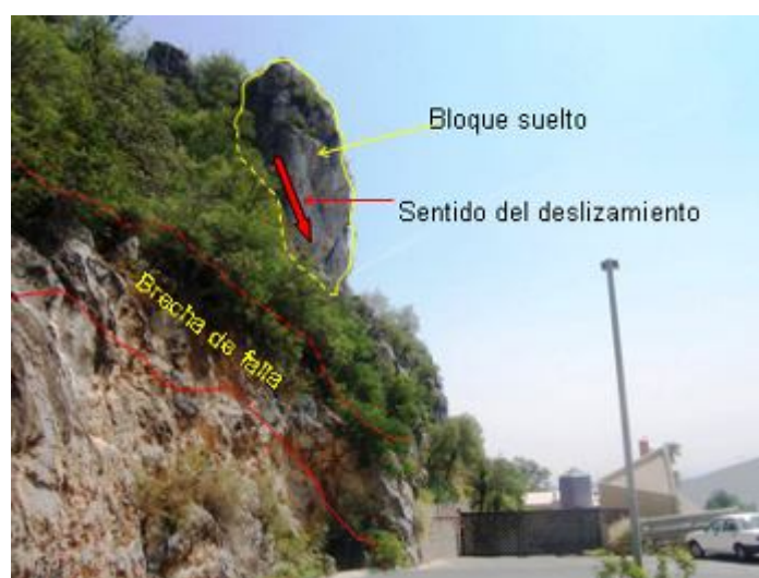
Fotografía 15. En el Cerro de La Corona, aparecen brechas que rellenan una falla, y un gran bloque en posición inestable; todo lo cual conforma una situación de alto riesgo.
