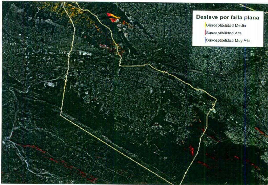
Figura 14. Detalle del Mapa de Puntos peligrosos para el Municipio de San Pedro Garza García para deslizamientos por falla plana. Para las zonas de susceptibilidad alta y muy alta se debe demostrar mediante los estudios de ingeniería adecuados, que los peligros pueden mitigarse para ser aprobados por la autoridad competente.
