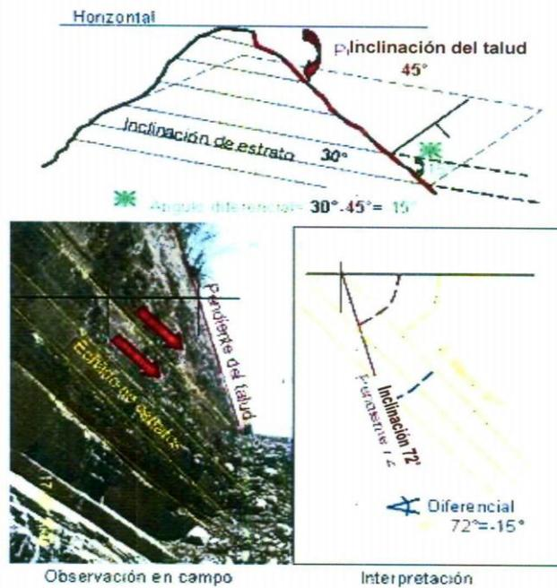
Figura 8. Arriba, esquema del manejo de datos para determinar el ángulo diferencial; izquierda, discontinuidades (amarillo) y pendiente de ladera (rojo); en la interpretación, ángulos de cada una de ellas, para la obtención del ángulo diferencial que determina la inestabilidad por falla plana.
