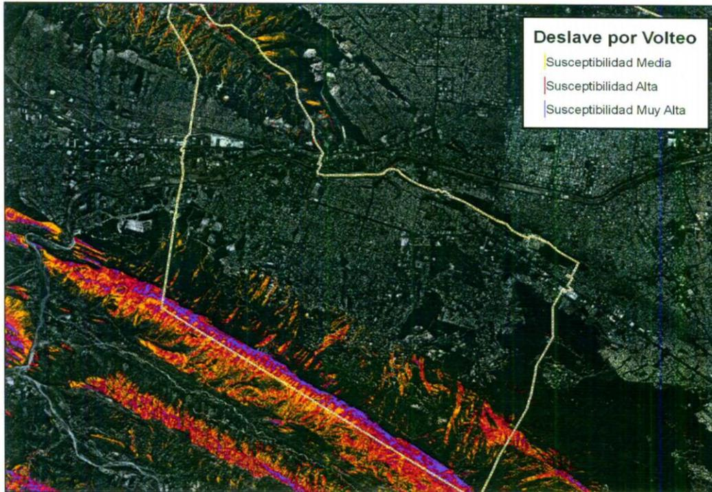
Figura 15. Detalle del Mapa de Puntos peligrosos para el Municipio de San Pedro Garza García para deslave por volteo. Para las zonas de susceptibilidad alta y muy alta se debe demostrar mediante los estudios de ingeniería adecuados que los peligros pueden mitigarse para ser aprobados por parte de la autoridad competente.
