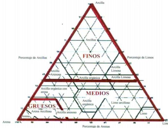
Figura 20. Triángulo de textura del suelo
