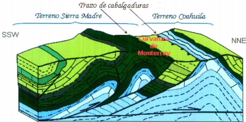
Figura 7. Bloque diagramático de las cabalgaduras en planta y en corte.
