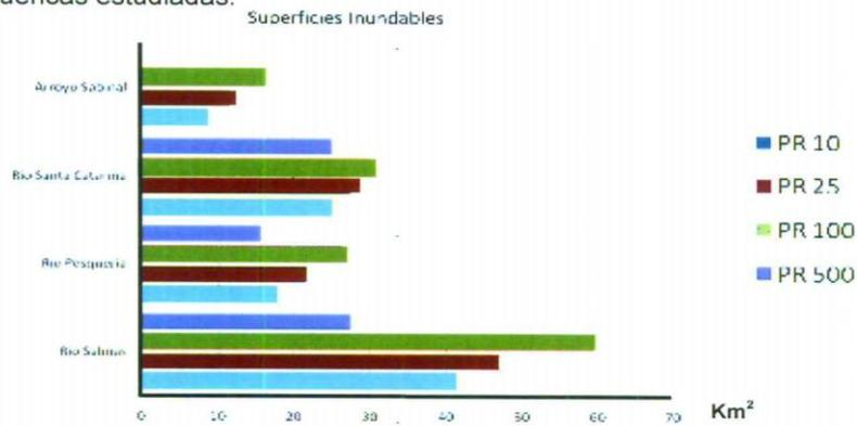
Figura 22. Superficie de las planicies de inundación, para los cuatro periodos de retorno.
