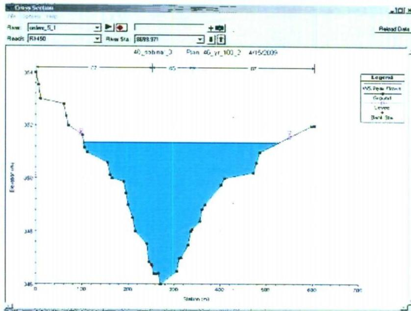
Figura 21. Ejemplo de sección del modelo hidráulico y altura del agua.
