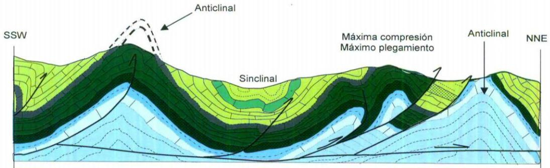
Figura 6. Corte que muestra la deformación mayor en los límites de la porción norte de la Curvatura de Monterrey.
