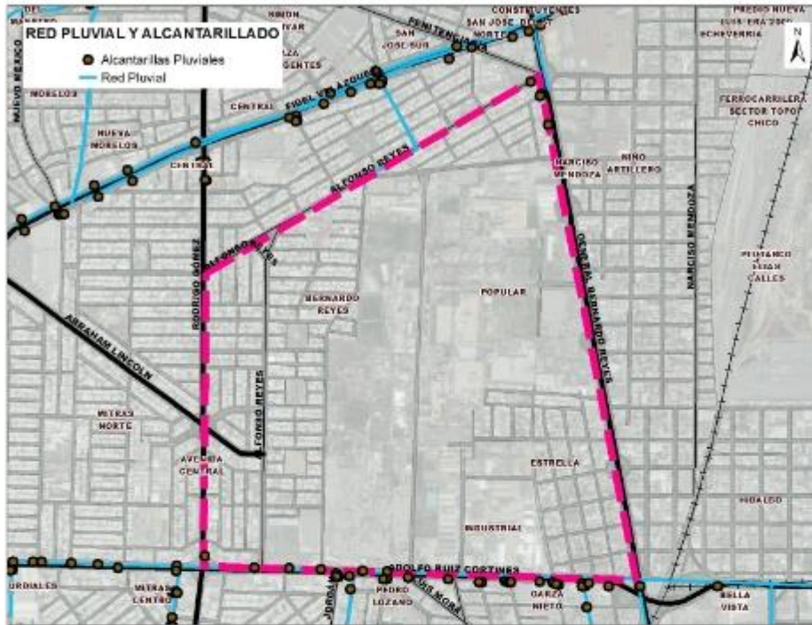
Mapa 9. Red principal de drenaje pluvial existente
